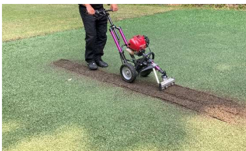
ゴルフ場の人工芝ティーグラウンド等に入り込み固着した土の除去
